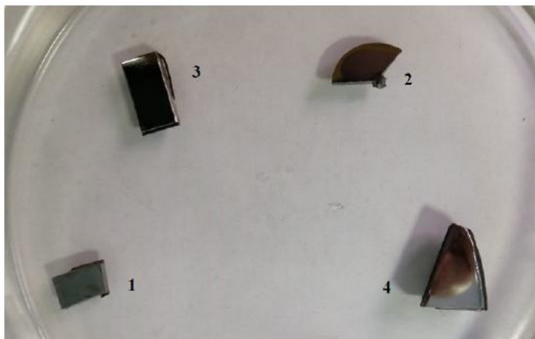
Рис.1. Готовые образцы стали разных марок: 1 – Конструкционная/ Углеродистая Обыкновенного качества; 2 – Конструкционная/ Легированная; 3 – (Медицинская)/ Специальная/ Легированная; 4 – Инструментальная/ Легированная/ Быстрорежущая
