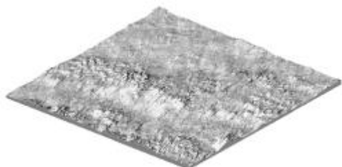
Рис.4. 3d-изображение поверхности образца 3- Сталь медицинская/ Специальная/ Легированная. Размер кадра 19,1 мкм
