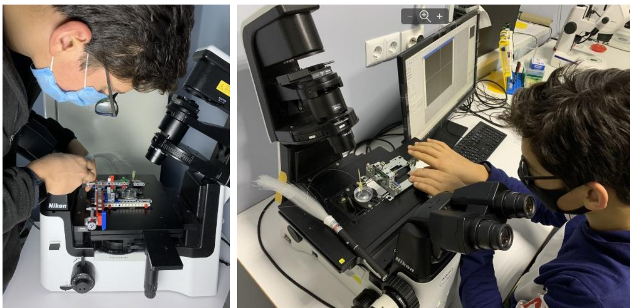
Рис.2. Подготовка оптоволоконных манипуляторов для микроскопа Nikon SMZ-1270 для проведения исследования на Trichoplax .
