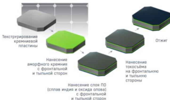
+ Эффективное использование площади. Благодаря низкому температурному коэффициенту из-за напыления легированных слоев аморфного кремния, высокая производительность при низких и высоких температурах и в плохой освещенности.
