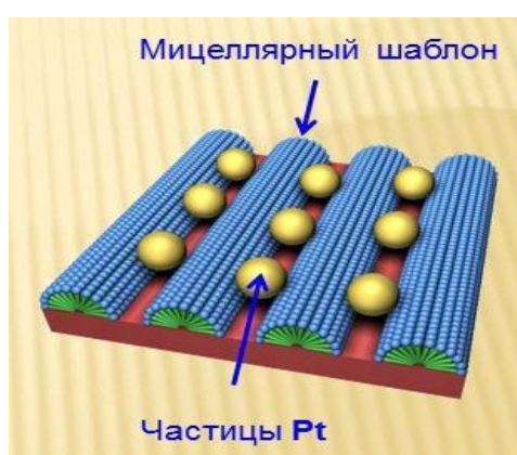
Схема осаждения нанопроводов платины
