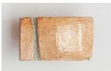
Рис. 2. Текстолитовая пластина для крепления полупроводникового фотоэлемента.
