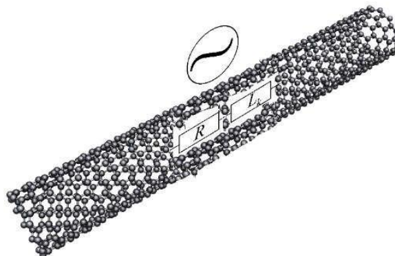
Рис.5. Эквивалентность углеродной нанотрубки активному двуполюснику
