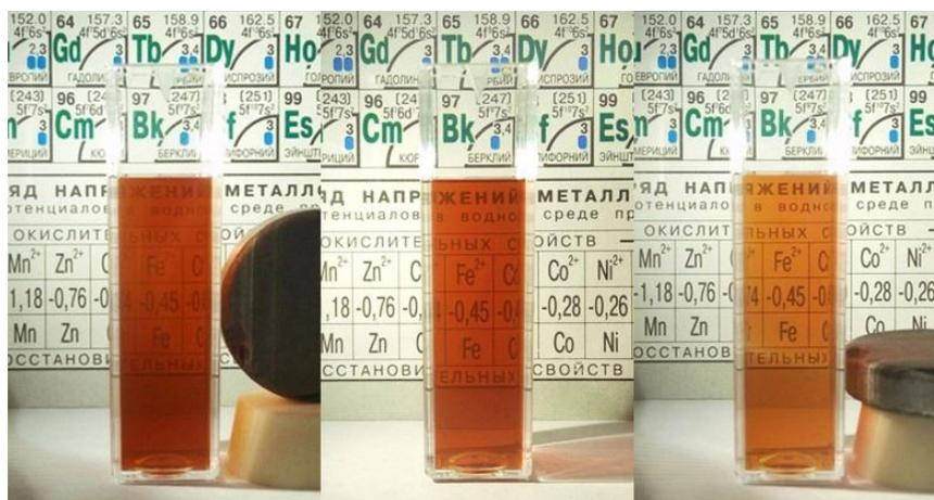
*Рис. 3. Коллоид в отсутствие магнитного поля и при применении поля в разных направлениях.*
