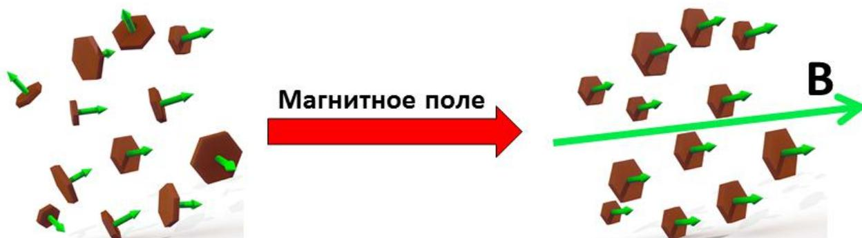
Рис. 5. Схема ориентирования частиц.
