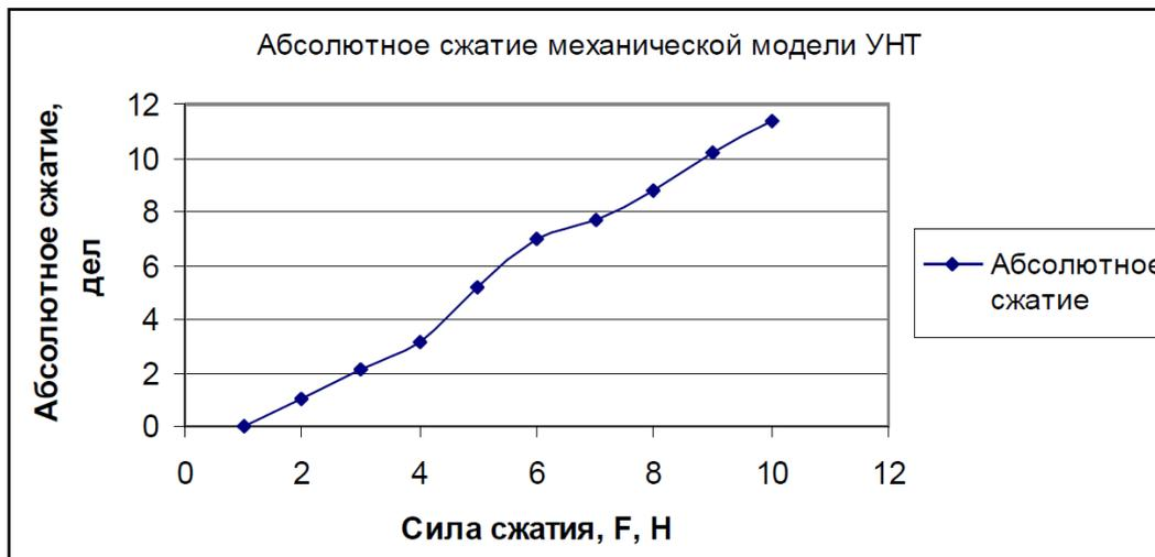
Рис. 8. Зависимость абсолютного сжатия модели УНТ от приложенной силы.
