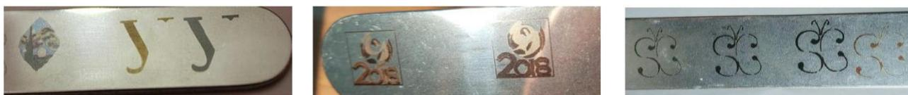
*Рисунок 6. Готовые изображения, полученные окислением поверхности стальной подложки (изображения автора)*
