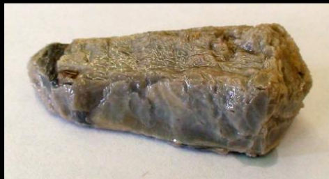
С поверхности кальций покрыт продуктами взаимодействия с воздухом
