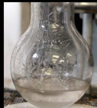
Иглы KHSO_4 на стенках колбы, в которой получали HCl из KCl
