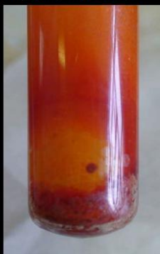
Бромиды фосфора PBr_5 ( PBr_4^+Br^- ) вверху и PBr_3 ( PBr_4^+Br_3^- ) внизу
