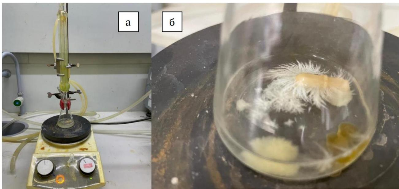
Реакционная установка (а) и выпавшие при охлаждении кристаллы продуктов реакции (б)
