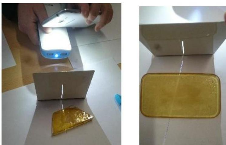
Фото 8-9. Определение показателя преломления
